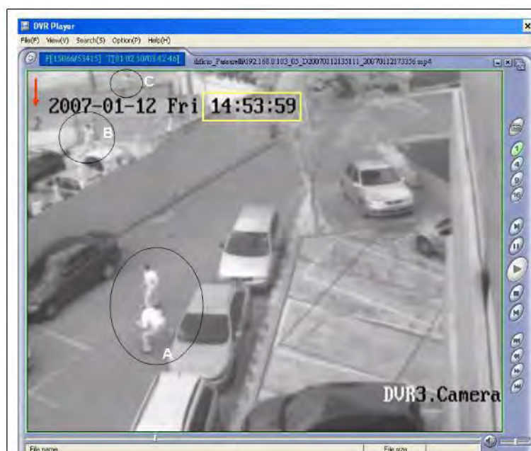
Figura 30 - Imagem capturada de uma das câmeras de segurança do Edifício Passarelli no instante do colapso. A seta no canto esquerdo da imagem mostra o aparecimento de trincas formadas na superfície do terreno durante o colapso do túnel. A = reação das pessoas que não tinham contato visual com a obra (provavelmente reagiram após intenso barulho e vibração no local). B e C = pessoas que tinham contato visual com a obra começaram a correr segundos antes da reação das pessoas que estavam localizadas no estacionamento do Edifício Passarelli.
